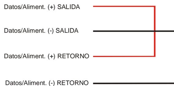
Figura 14 - Ligação do loop - loops não utilizados
